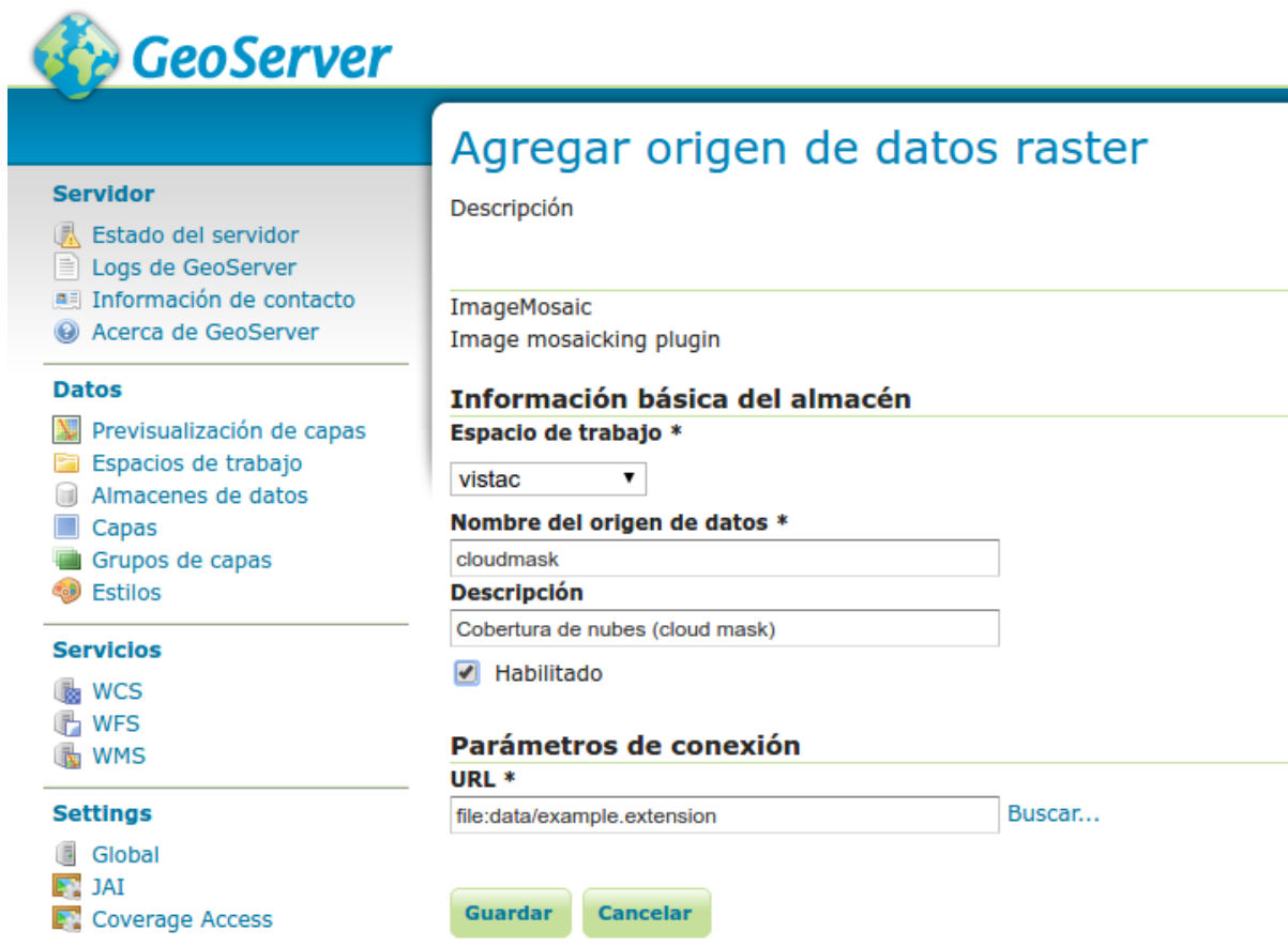
Figura 10. Diálogo en geoserver para agregar un mosaico de imagenes indexado por fecha
